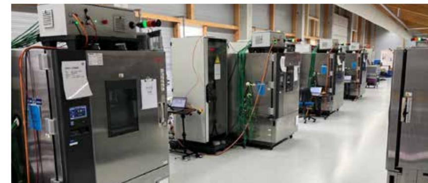
Blick ins Innere des neuen Labors: Klimakammern mit Prüfaufbauten für Prüfungen an New Energy Vehicle Komponenten.
